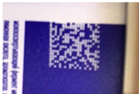
Отсутствие зоны покоя с одной из сторон
